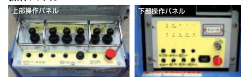
緊急時の降下に関して、上部・下部操作パネルに非常用ポンプスイッチを新設しました。また、包括安全基準としてフートスイッチを踏まなくてもエンジンの始動が可能になりました。(機種によって写真と異なります。)
